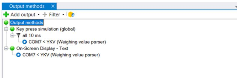
Die Baumstruktur zeigt an oberster Ebene alle Ausgaben sowie Filter, die bislang keiner Ausgabe zugeordnet sind.
