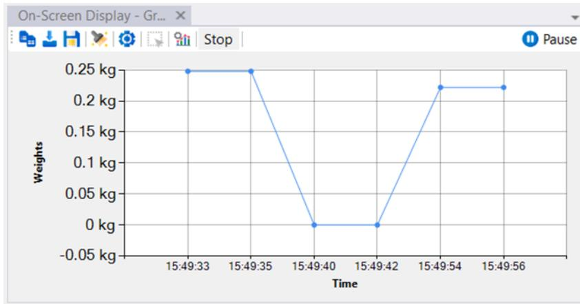
Dieses On-Screen-Display erlaubt es Messwerte in einer Diagramm- / Grafikdarstellung (über die Zeit aufgetragen) aufzunehmen.
