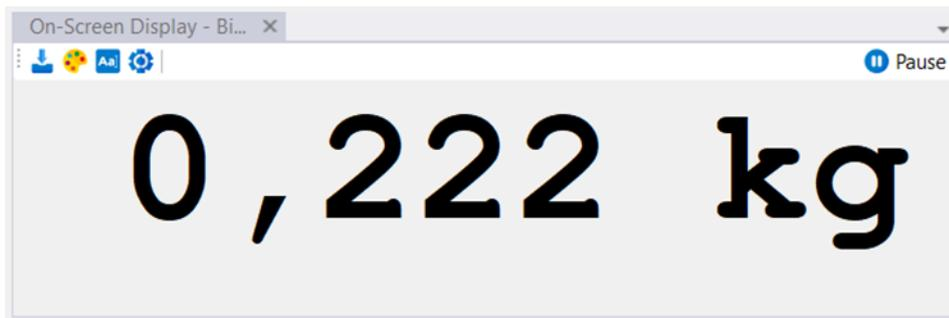
Die Großanzeige zeigt das Ergebnis der Anwendung eines Ausgabemusters auf ein eingehendes Datenpaket in großer Schrift und in einer benutzerdefinierten Farbe an.
